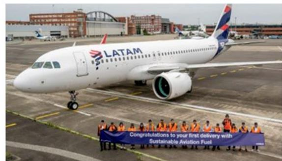
ova aeronave A320neo incorporada à frota da Latam Airlines, após voo da fábrica da Airbus em Toulouse (França) para Fortaleza (Ceará) utilizando 30% de SAF de óleo de cozinha usado
